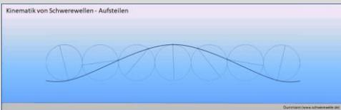
Veranschaulichung des Aufsteilens einer Schwerewelle unter Verwendung der Darstellung der Orbitalbewegung. (Die Geschwindigkeit der Orbitalbewegung ist konstant.)
